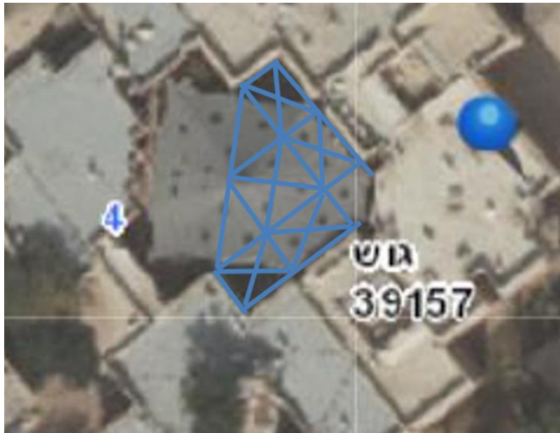
סכמת חיזוק מפלס תקרת הגג באמצעות פרופילי פלדה (דוגמה בלבד)
